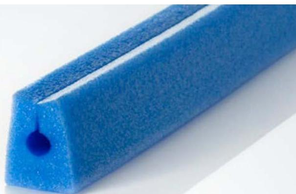
Kantenschutz mit oder ohne Innenlochverstärkung für Produkte mit einer Kantenstärke von 6 bis 12mm. Speziell für Produkte mit Wulst oder Dichtung geeignet. Das Profil wird auf Spule zum Selbstablaugen geliefert.
